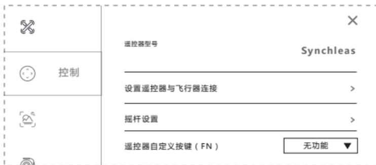
② 选择“设置遥控器与飞行器的连接”，扫描无人机。
